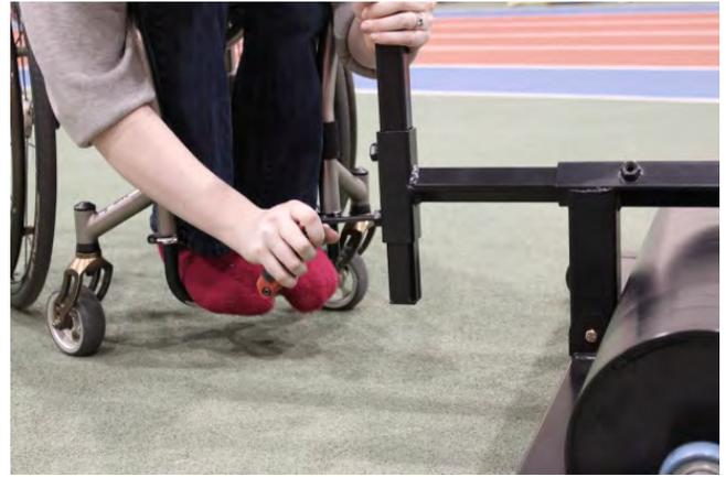
Placez la barrure sur le poteau droit en la soutenant d'une main, et serrez là sur le poteau en utilisant votre clé Allen de l'autre main. Vous allez devoir réajuster la hauteur de la barrure lorsque vous allez installer votre chaise sur le rouleau.
