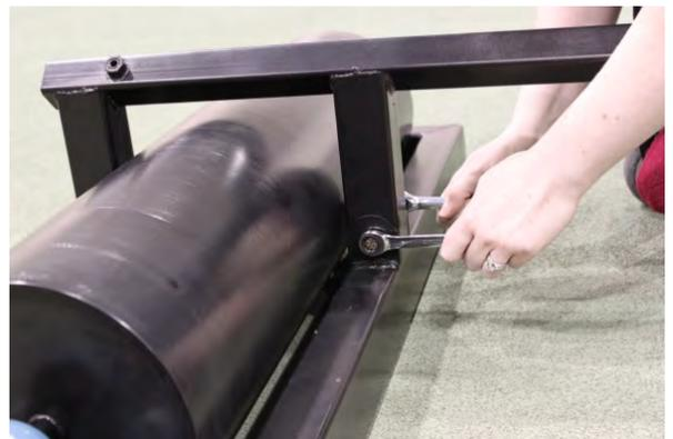
Insérez le poteau en "T" à l'arrière du poteau en "F". Utilisez la clé Allen approprié afin de serrer le poteau en place. Le poteau en "T" aura besoin d'être ajusté à nouveau lorsque vous allez installer votre chaise de course sur le rouleau.
